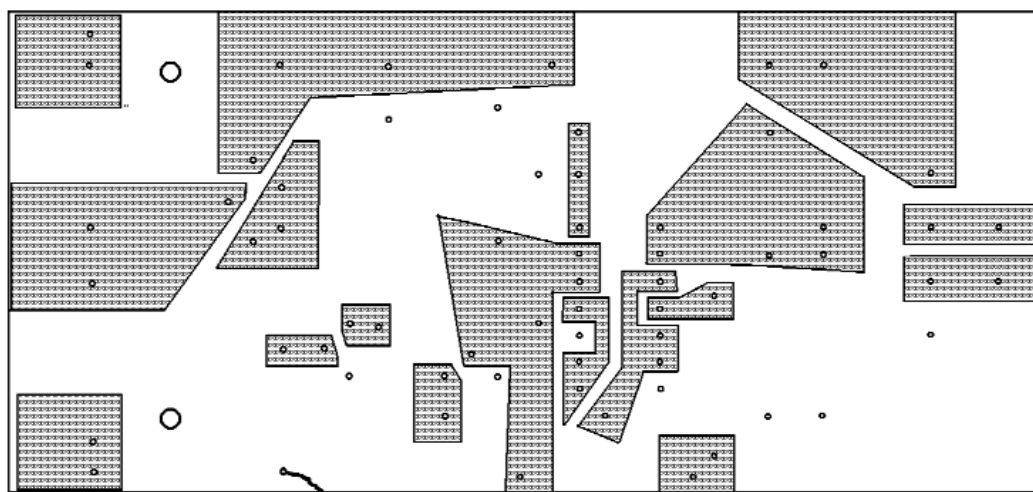
Отверстия, расположенные вне заштрихованных дорожек, предназначены для соединения деталей с "массой".
